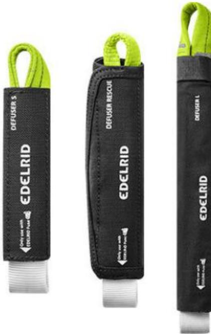
Con su serie DEFUSER, EDELRID ofrece no solo uno, sino tres amortiguadores para conectar el FUSE. Se trata de dispositivos compactos para cargas de usuario de hasta 140 kg (versión RESCUE hasta 220 kg) que reducen significativamente la fuerza de impacto generada en caso de caída.
