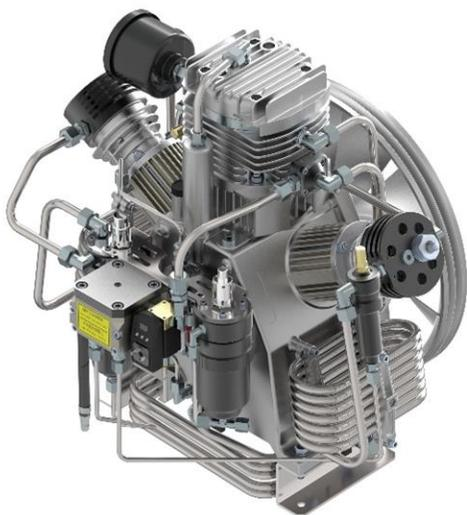
Los cojinetes del cigüeñal tienen rodillos, extremadamente robustos y fabricados en Europa que garantizan una larga vida útil del compresor. Una bomba de aceite proporciona una lubricación constante en el funcionamiento interno del bloque, con aceite limpio de impurezas por un filtro y por un imán que captura cualquier metal presente en el aceite lubricante. El enfriamiento por aire comprimido se obtiene mediante bobinas de enfriamiento de acero inoxidable entre etapas.
